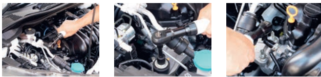
エンジンルームの整備作業に ソケットの延長に(エクステンションバー) 入組んだ場所での作業に(ユニバーサルジョイント)
