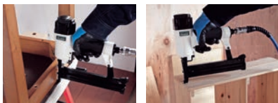
ステープル 仕上釘(ネイル) ステープルと仕上釘を入れ替えるだけで両方の作業が可能
