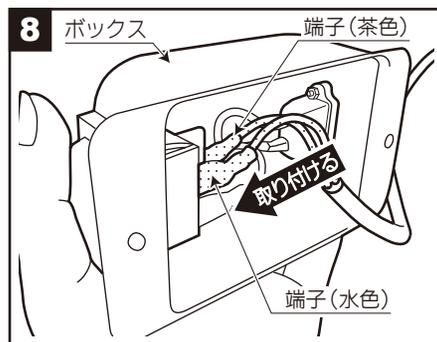
ライトのコードと端子を外した時の逆の手順で取り付けて下さい。
