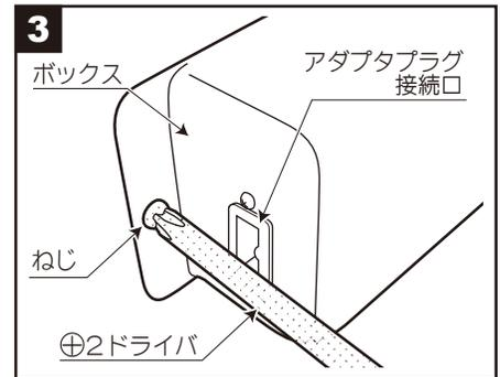
ボックスを固定しているねじ(2ヶ所)を⊕2ドライバで外します。
