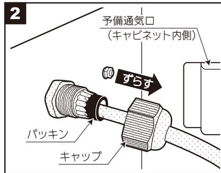
ボックスの裏側にあるキャップとゴムパッキンを外してコード上にずらして置いて下さい。
