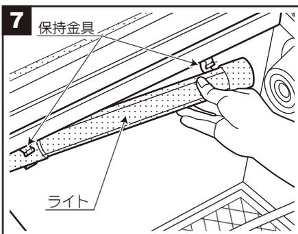
新しいライトを保持金具に留めます。銀色の反射用のシートがついている面を背面にして取り付けて下さい。
