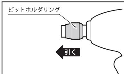
②ビットホルダリングを引いた状態のまま、ビットを差し込みます。奥まで差し込んだら、ビットホルダリングを放してください。ビットが固定されます。
