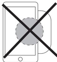
ワイヤレス対応機器が充電エリアの中心からずれていると充電が停止します。
